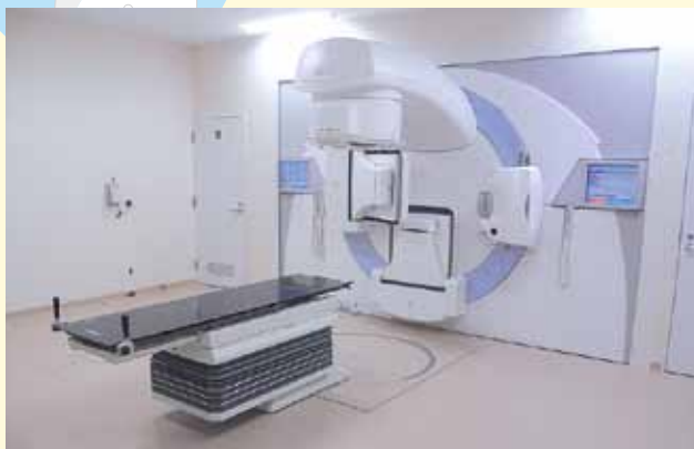
放射線治療装置 (リニアック) ELEKTA Synergy
